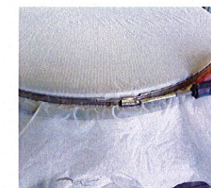
④金網押えリングを締付
